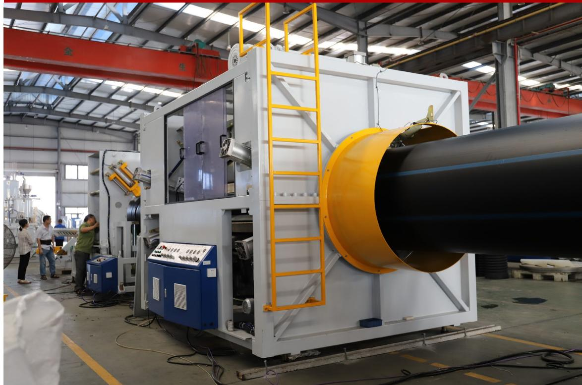
Диапазон регулирования скорости свыше 30, используется собственный независимый серводвигатель Liansu. План синхронного сервоуправления по типу «один привод для нескольких двигателей», чтобы гарантировать стабильность при низкой скорости вращения и адекватный выходной крутящий момент (гарантирует быстрое формование труб большого диаметра и высокого давления).
