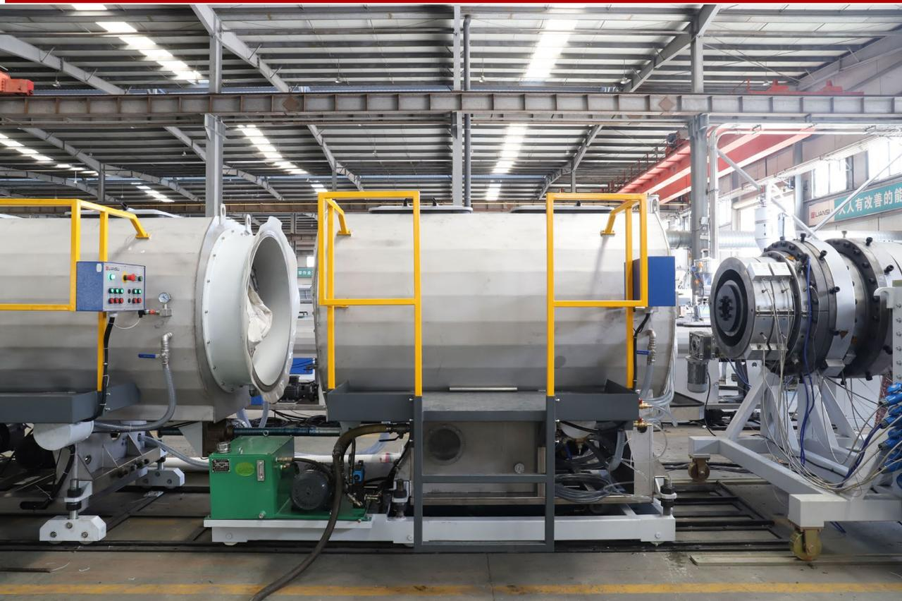
Гидравлическая система перемещения для вакуумных резервуаров 2 м и 8 м экономит затраты на рабочую силу.
