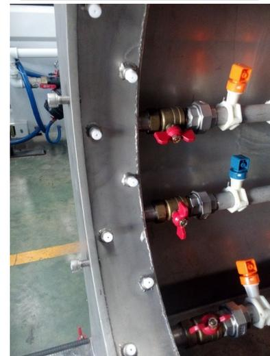
Патрубки оснащены съемными насадками-соплами, распределенными по окружности. Водяное кольцо распыляет водяную дымку с хорошим конусным эффектом. Легко чистится, не блокируется и имеет хороший охлаждающий эффект.
